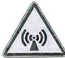
pericolo radiazioni elettromagnetiche
